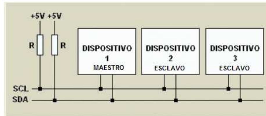
FIGURA 1. Conexión básica del bus I 2 C.
